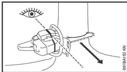
Данная бензопила предусмотрена с валовой планкой на кожухе и корпусе вентилятора. Использовать данную валовую планку.
