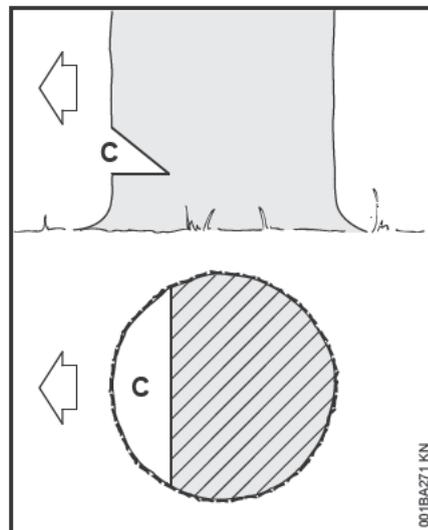
Подпил (C) определяет направление валки дерева.
