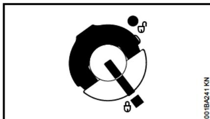
Крышка бака зафиксирована
