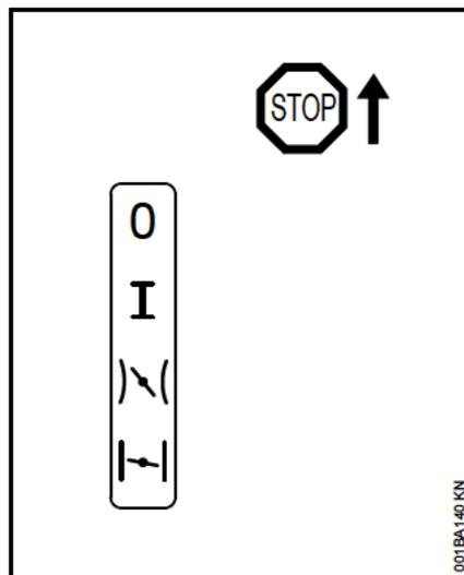
**STOP-0** – двигатель остановлен – зажигание выключено
