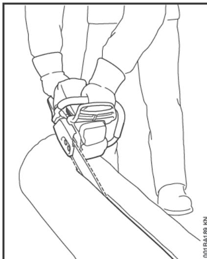
Техника пиления без использования зубчатого упора – опасность втягивания – направляющую шину устанавливать под как можно более плоским углом – работать особенно осторожно – повышенная **опасность обратного удара!**
