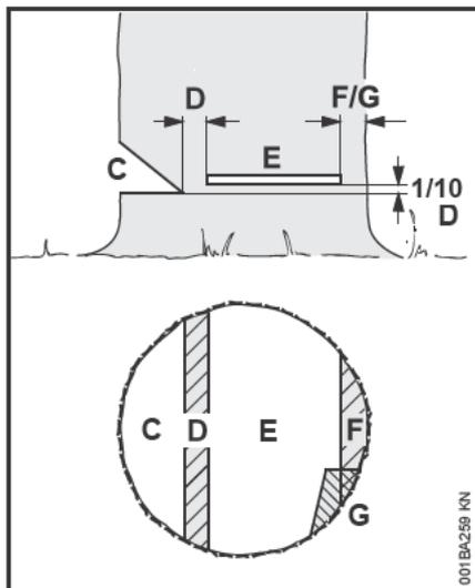
**Подпил (C)** определяет направление валки дерева.
