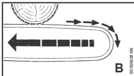
Если при пилении верхней стороной направляющей шины – обратный пропил – пильная цепь защемляется или наталкивается на твердый предмет в древесине, то пила может быть отброшена в сторону пользователя – **во избежание этого:**
