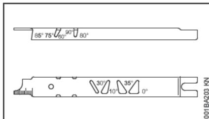
Пользоваться опилочковым шаблоном STIHL (специальные принадлежности, см. таблицу "Инструменты для заточки") – универсальный инструмент для контроля угла заточки и переднего угла, высоты ограничителя глубины, длины зуба, глубины паза и для очистки пазов и впускных масляных отверстий.
